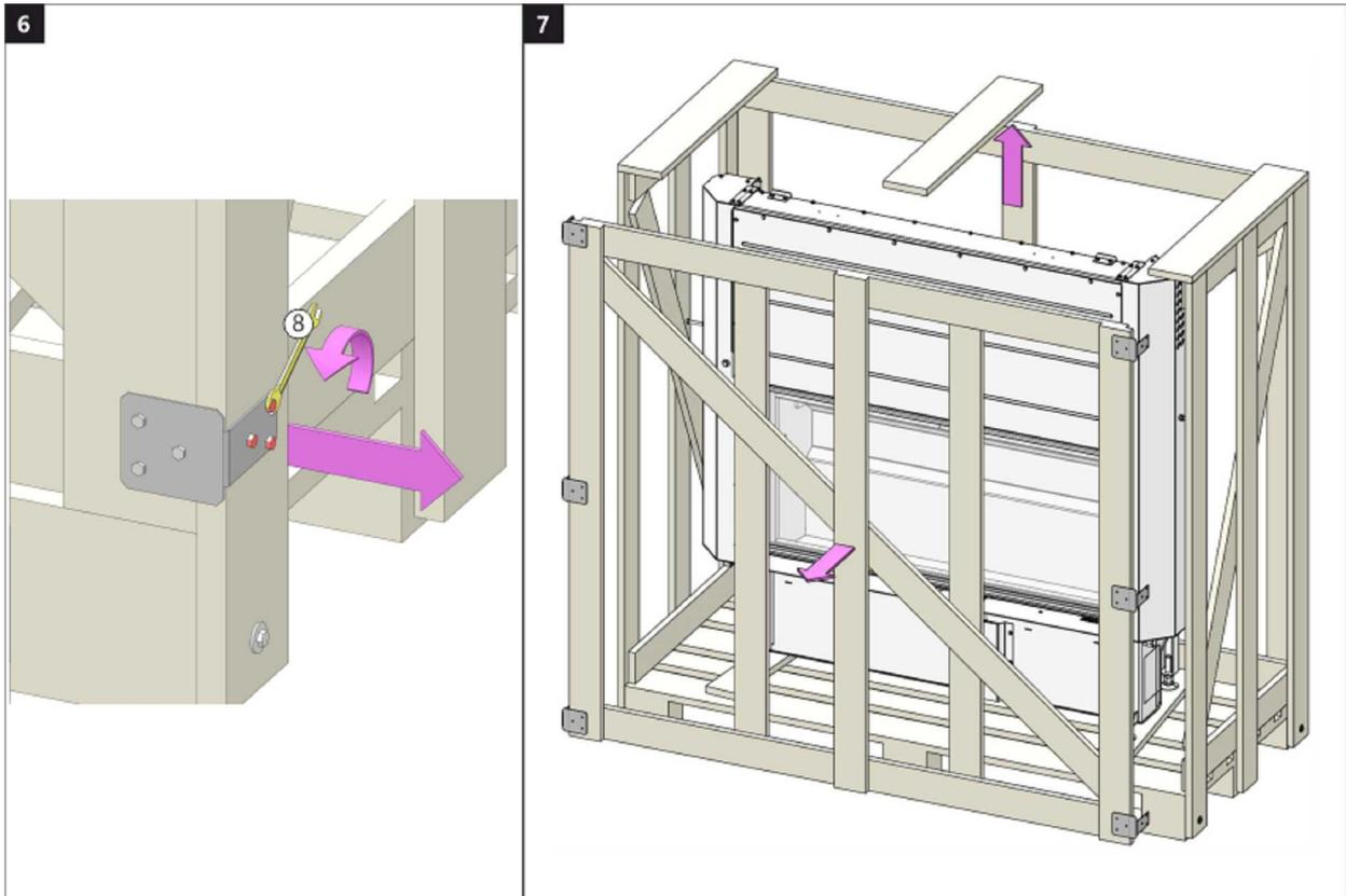
Disassembly of wooden packaging 4 | Lattung entfernen 4 | Démontage de la caisse en bois 4 | Smontaggio dei pannelli 4
