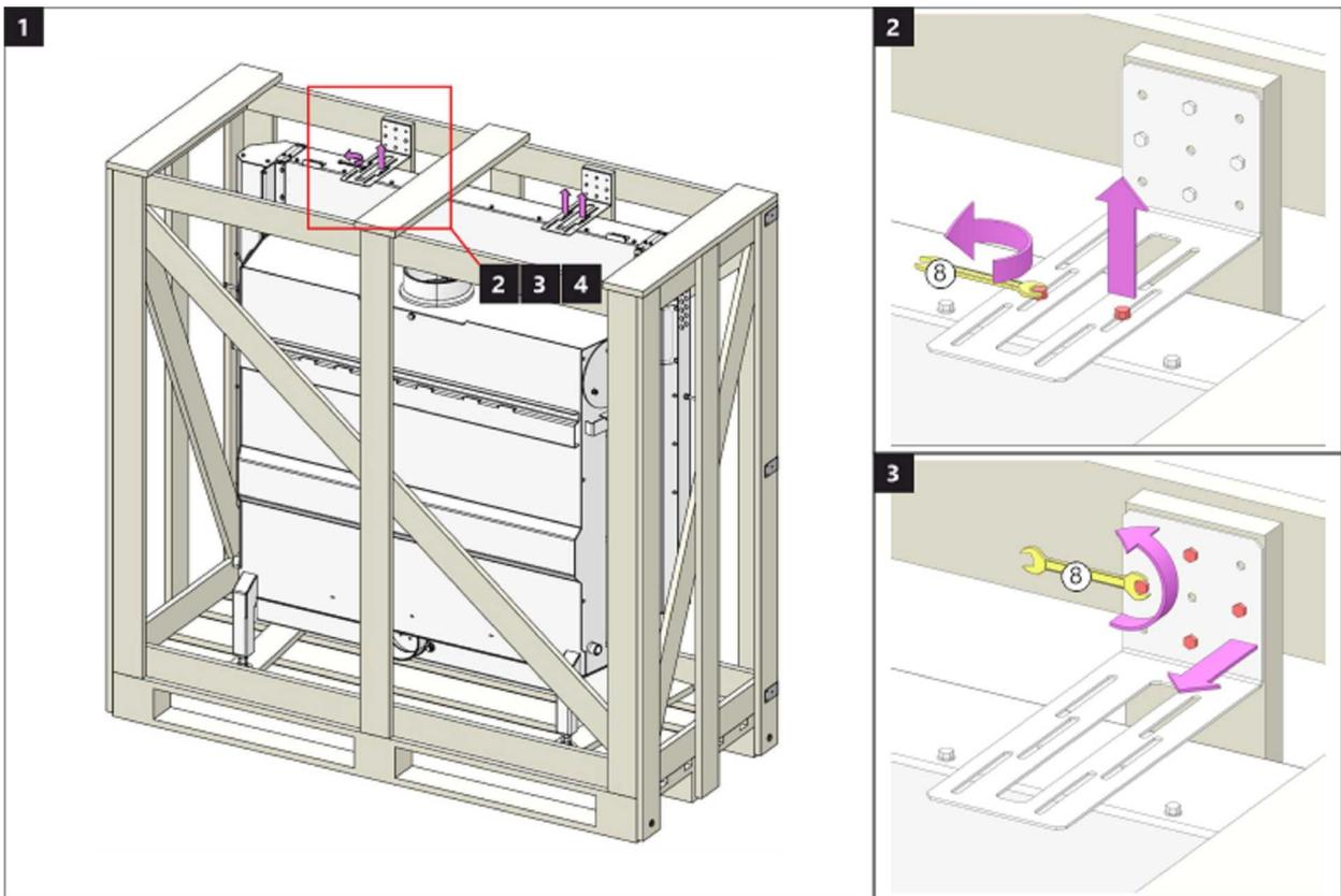
Disassembly of wooden packaging 2 | Lattung entfernen 2 | Démontage de la caisse en bois 2 | Smontaggio dei pannelli 2
