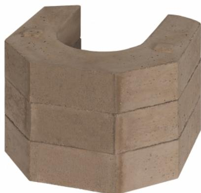
Lo speciale set refrattari d'accumulo che viene fornito con la stufa e alloggia nella parte superiore alla camera di combustione, permette di trattenere il calore della stufa fino a 4 ore. Peso 30 kg.
