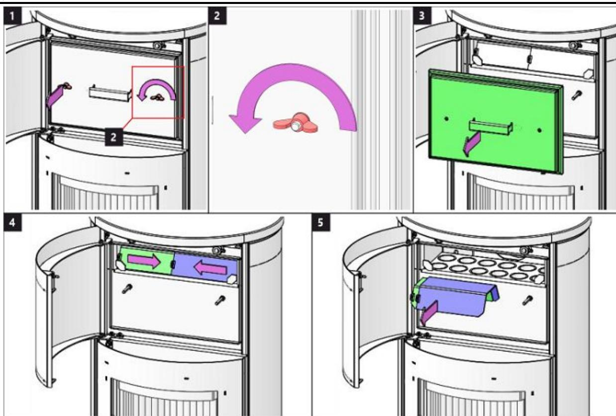
**Cleaning of flue gas path 2 | Reinigung Rauchgaswege 2
