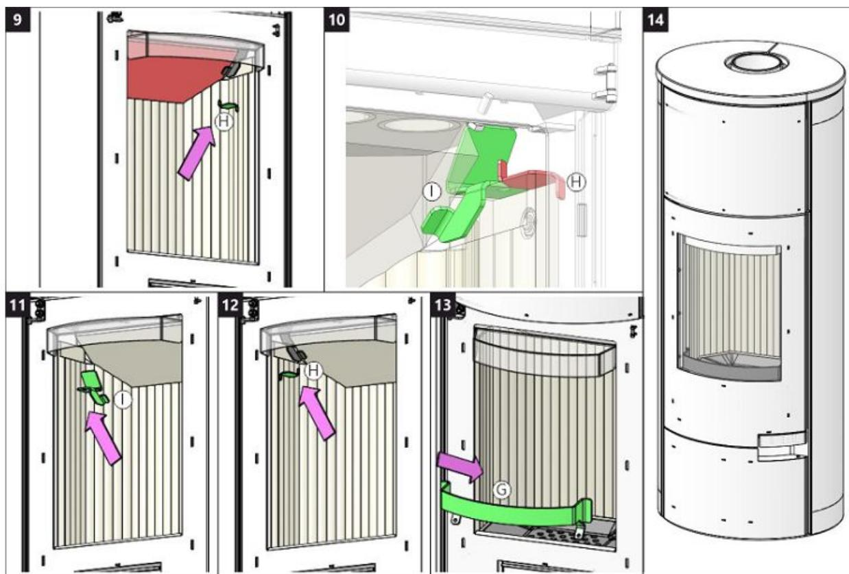
**Cleaning of flue gas path 1 | Reinigung Rauchgaswege 1
