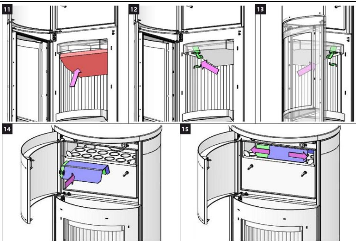
**Cleaning of flue gas path 4 | Reinigung Rauchgaswege 4
